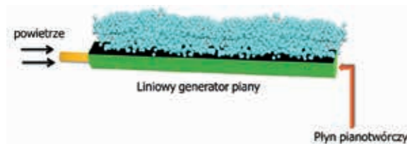
Zasada działania liniowego generatora piany w cieplarni II generacji.
