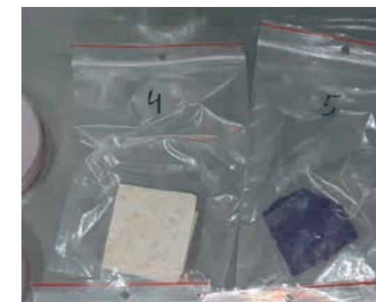
Wytopione płytki z koncentratu polipropylenu zawierającego 100 ppm nanoAg, poddane następnie testom na bakteriobójczość
