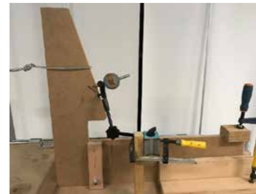
Ryc. 3. Stanowisko badania wytrzymałości podzespołów.
