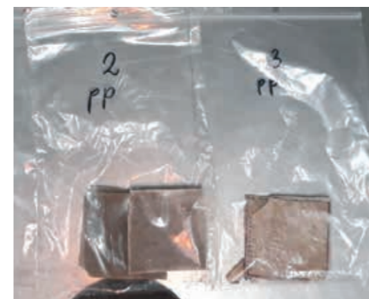
Wytopione płytki z koncentratu polipropylenu zawierającego 100 ppm nanoAg, poddane następnie testom na bakteriobójczość
