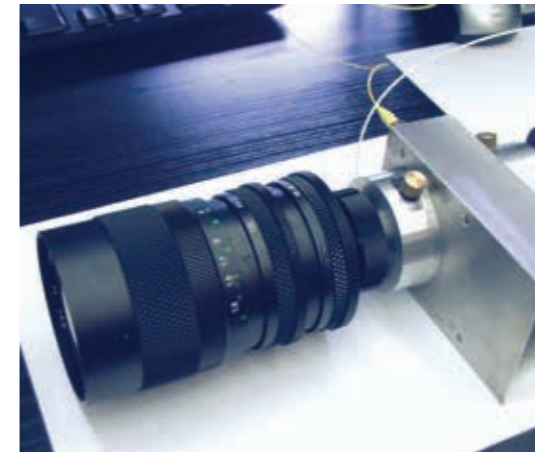
Rysunek 2. Prototyp kamery zaopatrzonej w układ soczewki cieplnej. Obiektyw oraz kamera, złącza i optyka w złączu przejściowym zaprojektowane i wykonane w ramach projektu.
