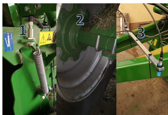
Rys. 3. Urządzenia pomiarowe zamontowane na prasie McHale
