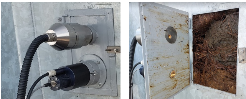
Rys. 2. Sondy spektrometru zainstalowane na burcie skrzyni ładunkowej rozrzutnika obornika
