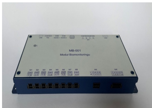
Ryc. 3. Moduł pomiarowy systemu biomonitoringu MB-001 ze zmienionym oprogramowaniem firmware
