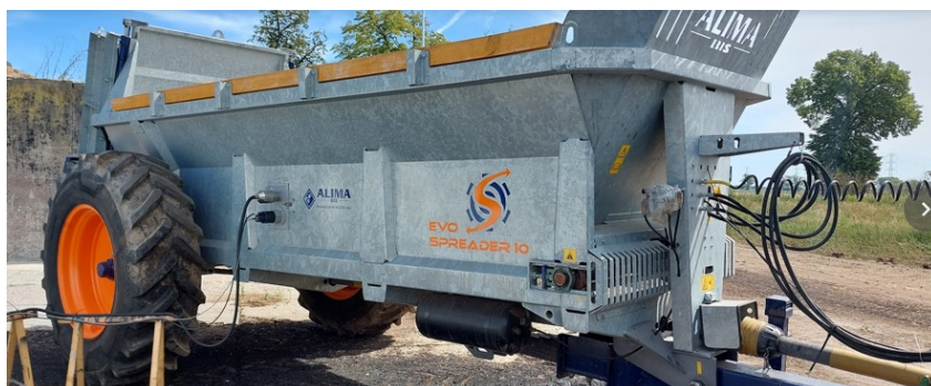
Rys. 1. Rozrzutnik obornika z zainstalowanymi sondami spektrometru
